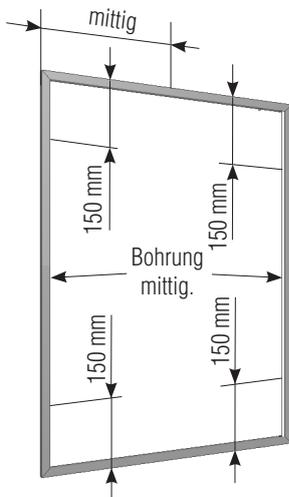
Montagerahmenprofile oben mittig und seitlich mit Bohrer  $\varnothing$  4,0 mm, von innen nach außen, nach den angegebenen Maßen (**Achtung: Blockmagnet in Rahmenprofil!**) vorbohren. Die innere Profilwand mit dem Zapfensenker 17 34 10 ansenken. Ab einer Höhe von 1800 mm 4 Bohrungen.
