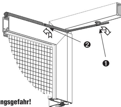
**! Die Feder steht unter Spannung! Verletzungsgefahr!**
