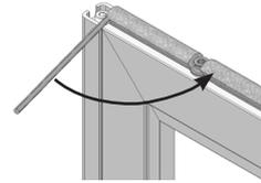
(1) Drehrahmen wie abgebildet mit dem unteren Drehbeschlag in das Aufnahmeteile stecken, zum Montagerahmen ausrichten. (2) Oberen Drehbeschlag mit dem mitgelieferten Inbusschlüssel auf Anschlag in Buchse einschieben und fest anziehen.
